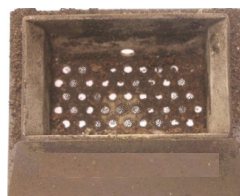
Vuurpot die gereinigd moet worden met de openingen verstopt met as
